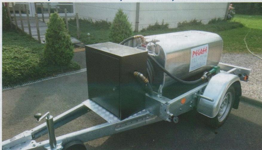
Réservoir alu 333 litres agréé UN1203 sur remorque galva ; armoire métal renfermant pompe atex 50 L /min, volucompteur, filtre aviation, flexible et pistolet automatique.
